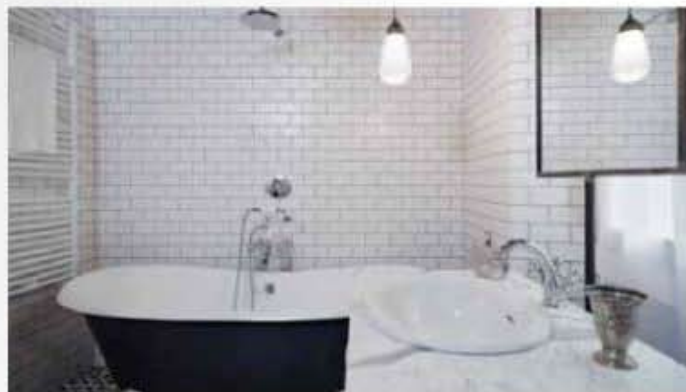
Il bagno padronale con la vasca freestanding in ghisa su piedini. Il lavabo è incassato in una struttura in ferro realizzata su disegno
